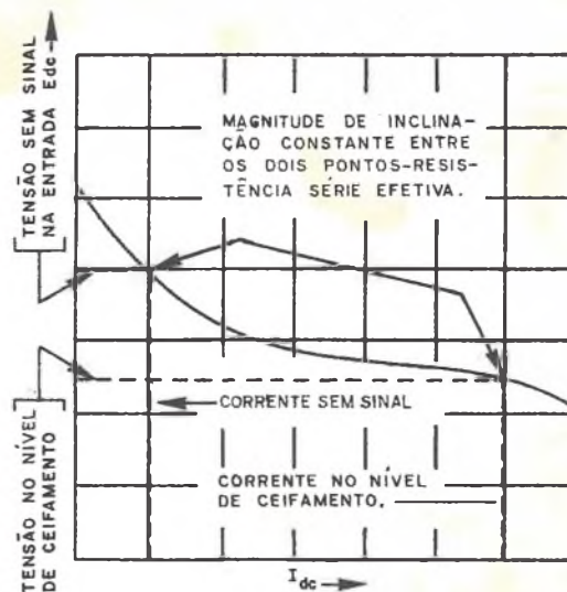
Curva de regulação para retificador com filtro capacitivo.
