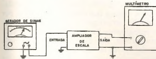
Figura 6: Orientação para calibragem do amplificador (opção 1 - leia texto).
