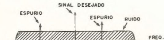
Figura 11 - Espectro habitual de uma portadora perturbada por ruído e espúrios.
