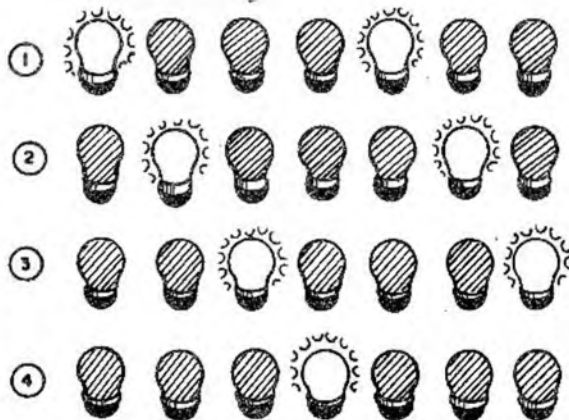
AS LÂMPADAS PARECEM "CORRER" PARA A DIREITA NESTAS 4 FASES DE OPERAÇÃO DO SEQUENCIAL
