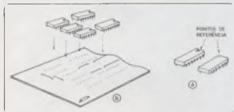
Figura 10 - A - Detalhe da colocação dos circuitos integrados na placa de fio impresso. B - Tipo de pontos de referência para colocação dos CI na placa.
