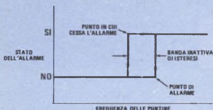
Fig. 4 - Isteresi della frequenza d'entrata in funzione dello stato dell'allarme. La differenza è inferiore a 3 km/h.
