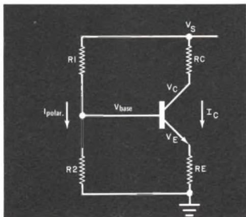
che per transistori diversi, pur dello stesso tipo, il beta può spesso variare in un ampio campo, ad esempio da 100 a 300.
