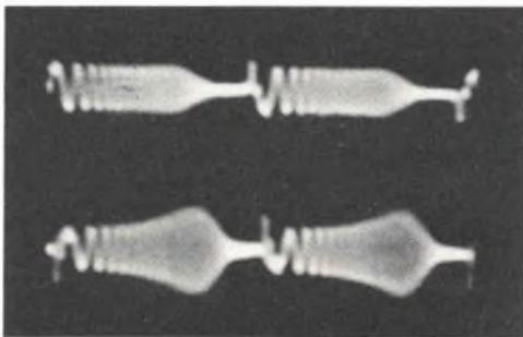
*Fig. 3 - La traccia superiore mostra la buona risposta in frequenza di un canale avente il giusto livello di premagnetizzazione. Una riduzione della premagnetizzazione (traccia inferiore) fa nascere un picco alle alte frequenze.*
