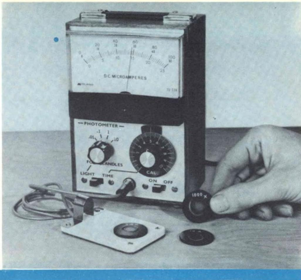
nale ad alta stabilità, che entra in funzione istantaneamente; non presenta derive ed è immune dalle variazioni della tensione di rete. Per sentire la luce misurata, viene usata una fotocellula al solfato di cadmio lineare e ad alta velocità.
