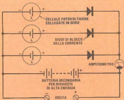
Fig. 5 - Cellule solari collegate in serie-parallelo.
