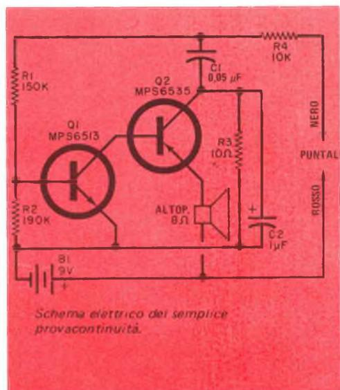
L'indicazione viene fornita dal provacontinuità tramite un segnale sonoro, per cui non occorre tenere d'occhio lo strumento mentre si eseguono prove su un circuito: si evita così il pericolo che un puntale possa scivolare mentre si osserva lo strumento, danneggiando la giunzione di semiconduttori. Con questo provacontinuità, una buona giunzione di diodo suonerà bene se polarizzata in senso diretto.
