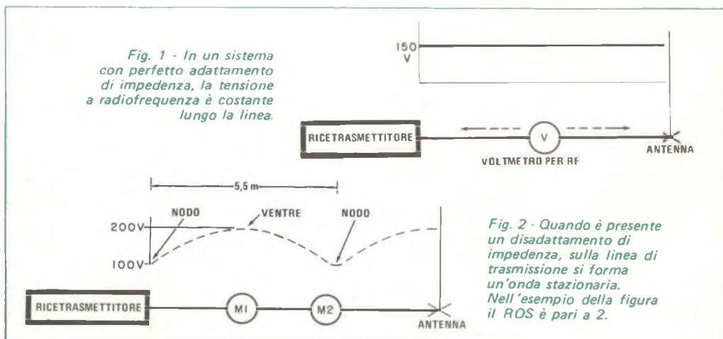
*Fig. 2 - Quando è presente un disadattamento di impedenza, sulla linea di trasmissione si forma un'onda stazionaria. Nell'esempio della figura il ROS è pari a 2.*
