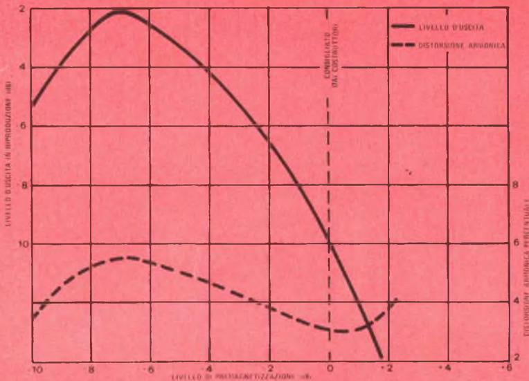
Fig. 2 - Influenza della corrente di premagnetizzazione sulle prestazioni alle alte frequenze. Le curve sono relative ad un segnale a 10.000 Hz registrato al livello di -10 VU.
