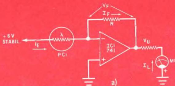
Fig. 1 - Circuito semplificato con amplificatore operazionale per misurare il livello luminoso (a) e per misurare il tempo di esposizione (b).
