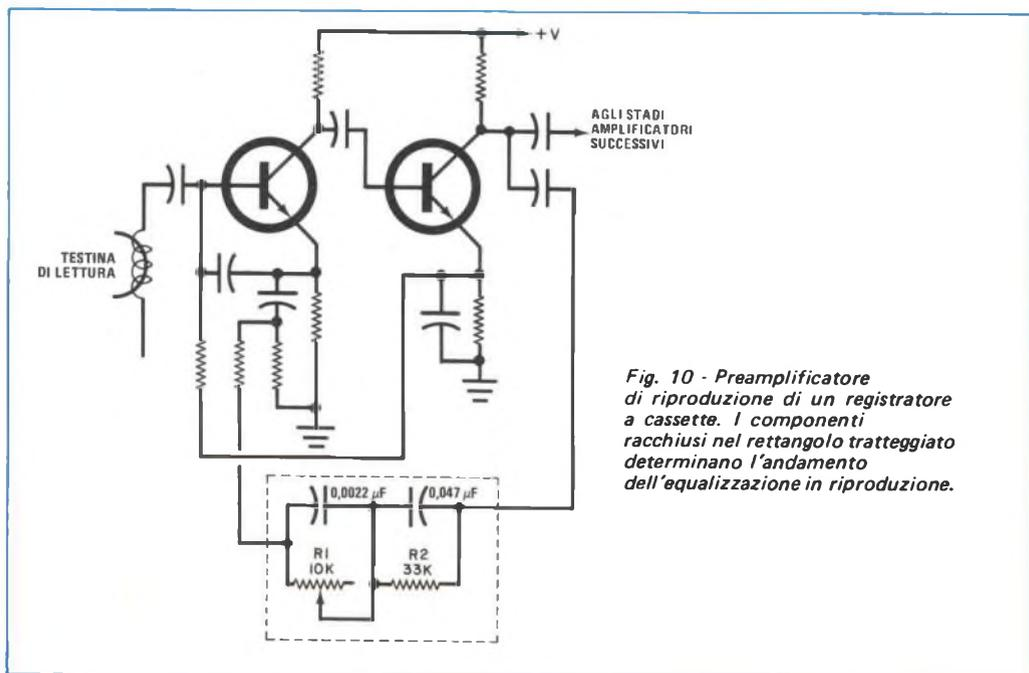
*Fig. 10 - Preamplificatore di riproduzione di un registratore a cassette. I componenti racchiusi nel rettangolo tratteggiato determinano l'andamento dell'equalizzazione in riproduzione.*
