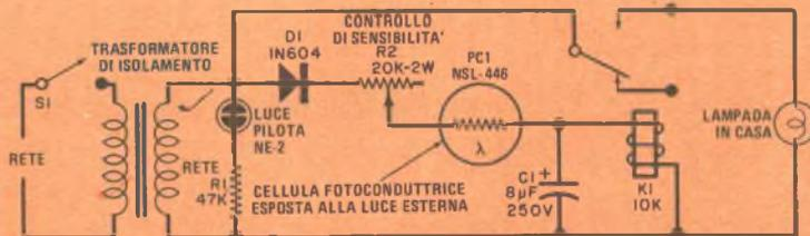
Fig. 1 - La semplicità di applicazione delle cellule fotoconduttrici è dimostrata in questo progetto costruttivo. Il "guarda-casa" cessa di condurre nella notte facendo aprire il relé ed accendere la lampada.
