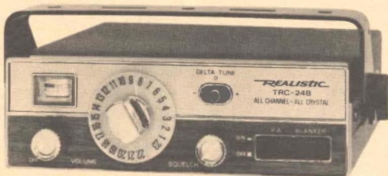
Un'unità per uso mobile a 23 canali, dotata di un efficiente circuito per la soppressione del rumore.
