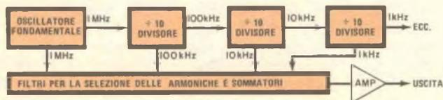
*Fig. 1 - Schema di principio per la sintesi di frequenza.*
