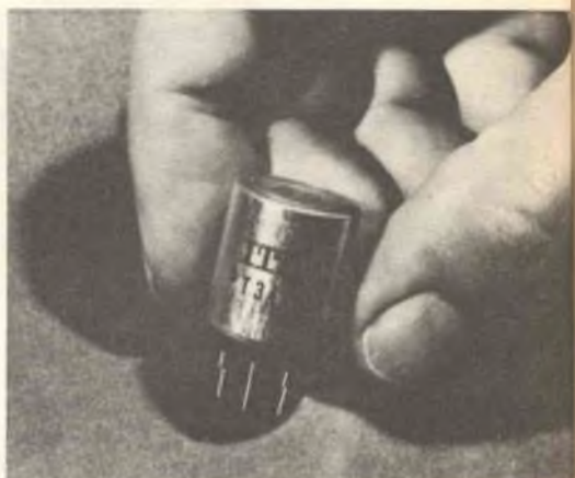
Fig. 3 - Termistore per la smagnetizzazione dei tubi a raggi catodici dei televisori a colori.
