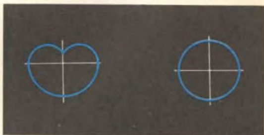
Fig. 1 - Diagramma polare di sensibilità di un microfono omnidirezionale (a sinistra) e di un microfono cardioide (a destra).
