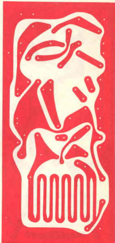
Fig. 7 - Nel disegno in grandezza naturale del circuito stampato per il rivelatore modulatore (riportato a destra) si nota la bobina oscillatrice RF stampata. Nel disegno a sinistra è illustrata invece la disposizione dei componenti.
