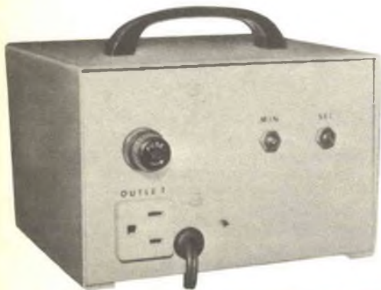
Sul pannello posteriore sono montati la presa d'uscita, il fusibile e i potenziometri di regolazione R2 e R3.
