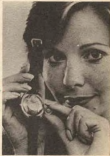
Un piccolo modello della pila installato sperimentalmente in un orologio che, così alimentato, dovrebbe funzionare per almeno due anni.
