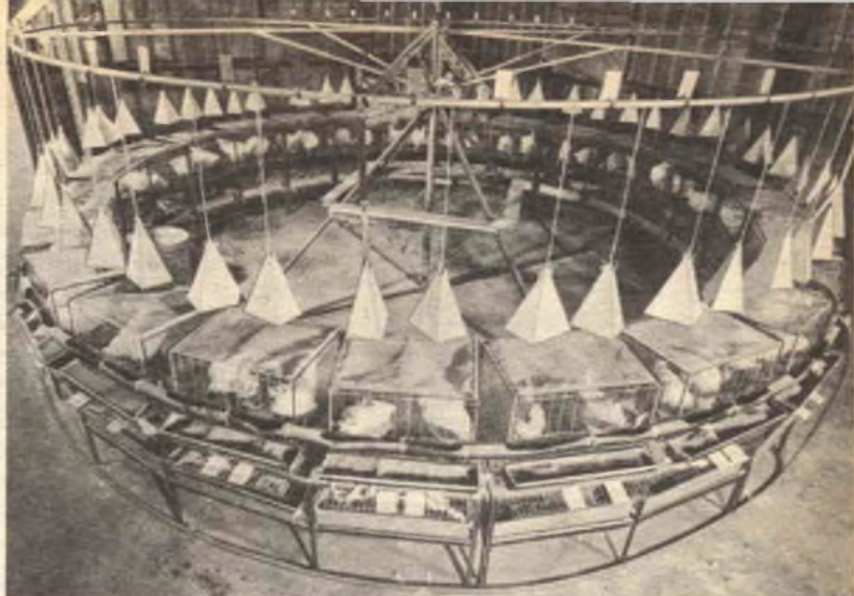
Fig. 3 - Giostra per prove sulle microonde per determinare le reazioni in uccelli viventi. Solo un cono è attivo, gli altri sono inefficaci.
