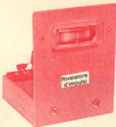
Fig. 3 - Il rivelatore dello stato di uscita usa uno strumento da pannello a zero centrale per il bilanciamento stereo.
