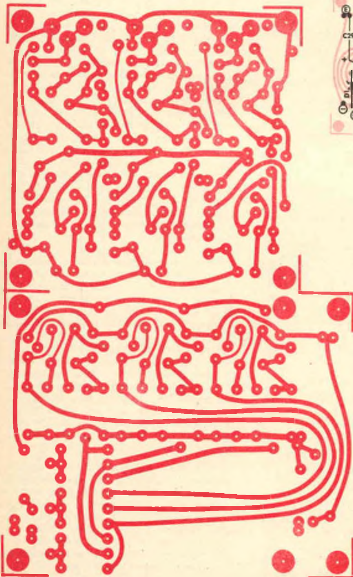
Fig. 3 - Circuiti stampati e disposizione dei componenti. Uno dei terminali dei resistori R49, R50 e R51 è collegato ad entrambi i circuiti stampati mentre corti pezzi di filo isolato collegano i punti marcati allo stesso modo dei due circuiti stampati.
