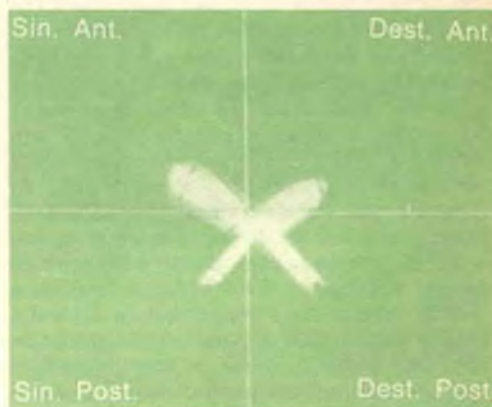
Fig. 2 - Una forma a X ben distinta rappresenta l'uscita ideale del segnale a 4 canali separati.
