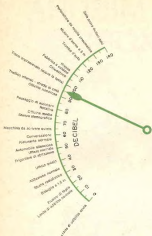
Fig. 1 - I suoni normali cadono in un campo compreso tra 0 dB e 140 dB. Gli strumenti che servono per misurare il suono danno letture in dB.
