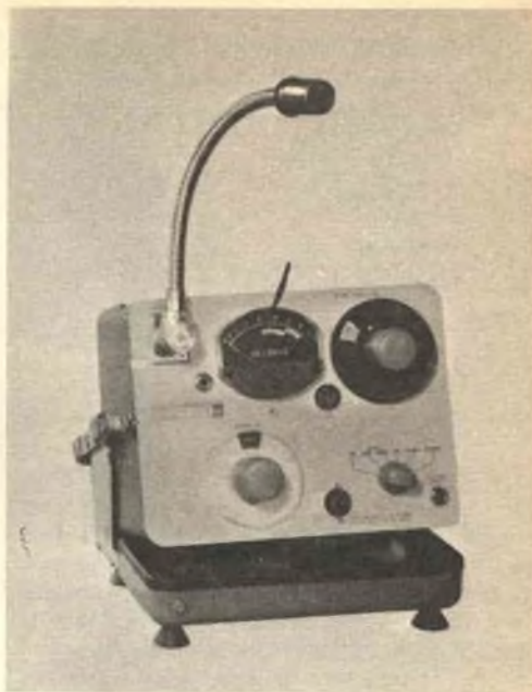
Un analizzatore di rumore a bande di un'ottava permette una rapida analisi armonica del rumore ed è di valido aiuto nell'identificazione e nel tratta e sorgenti separate delle diverse componenti del rumore.
