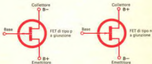
Fig. 2 - Ecco i simboli schematici per i transistori ad effetto di campo con giunzione di tipo p (a sinistra) e di tipo n (a destra).
