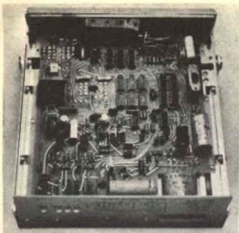
Tutti i componenti sono sistemati su un unico circuito stampato con speciali zoccoli di supporto per i circuiti integrati.
