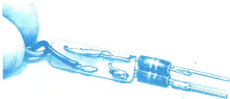
Vista della faccia inferiore della basetta di plastica dell'elemento sensibile, che mostra come i terminali dei componenti sono saldati insieme sia per realizzare il circuito sia per assicurare un solido montaggio dell'insieme.
