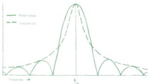
Fig. 3 - Le curve dei convenzionali circuiti sintonizzati LC e dei dispositivi preresonanti sono simili.
