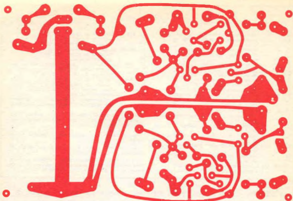
Fig. 2 - Circuito stampato in grandezza naturale per l'equalizzatore. I circoletti agli angoli indicano i fori di montaggio.
