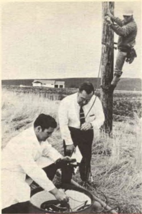
Per raccogliere dati che consentano di localizzare un CAT, tecnici della General Telephone & Electronics usano onde infrasoniche di bassa frequenza che si vengono a creare quando, per varie cause, all'aria viene ceduta dell'energia.
