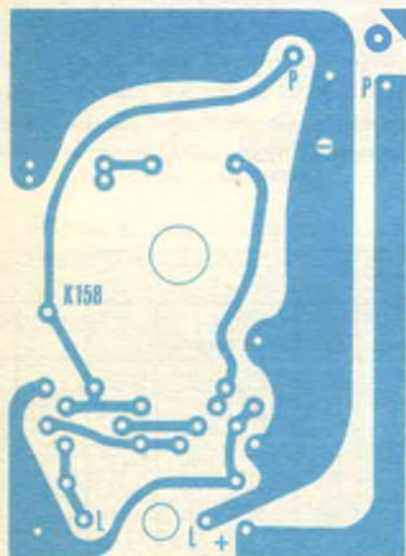
Fig. 3 - Illustrazione del circuito stampato, in grandezza naturale.
