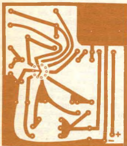
Fig. 3 - Circuito stampato in grandezza naturale (a sinistra) e disposizione dei componenti (a destra). Nel montare i componenti, è necessario rispettare l'orientamento di IC1 e le polarità dei condensatori elettrolitici.
