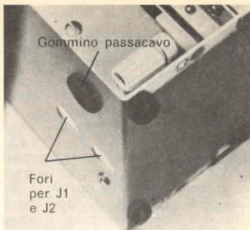
Nella parte posteriore della scatola devono essere praticati fori per l'uscita di J1 e J2 e per l'accesso alla vite di regolazione di C2. Questo foro deve essere guarnito con un gommino passacavo.
