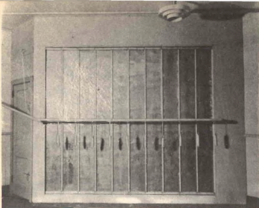
Con il filtro in questa posizione, si eliminano le frequenze oltre i 5.000 Hz. La leva a sinistra comandava gli sportelli del filtro per un rapido passaggio da un responso in frequenza all'altro.
