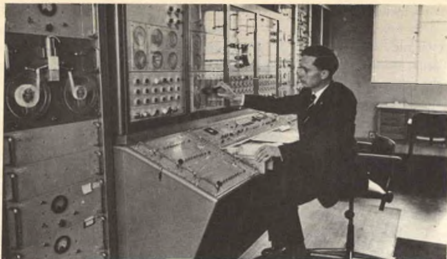
In questa foto sono visibili i controlli di uno dei radiotelescopi dell'Osservatorio Mullard, le cui tre antenne sono controllate automaticamente dal programma inciso sul nastro che si vede a sinistra. Le lancette sulla console rivelano in quale direzione sono orientate le antenne.
