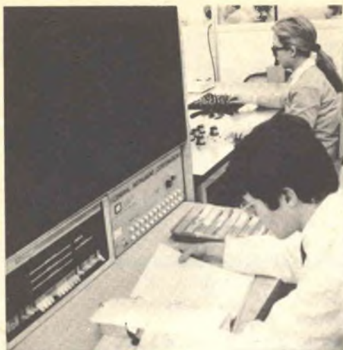
Fig. 4 - Un calcolatore elettronico verifica le funzioni circuitali di un dispositivo MTNS, prodotto presso lo stabilimento di Giugliano.
