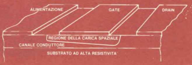
Fig. 2 - Transistore ad effetto di campo a "gate" di Schottky.
