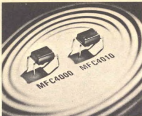
Questa nuova serie di circuiti integrati di consumo comprende un amplificatore audio ed un amplificatore a larga banda ad alto guadagno.
