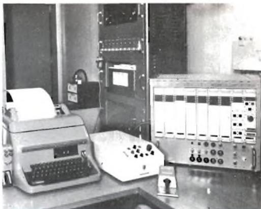
Cabina radio della Motonave "Bergehus"; a destra e di lato rispetto al banco di controllo dell'operatore è chiaramente visibile il Simplex-Tor.
