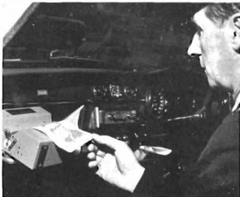
Denominata "Mufax", l'ingegnosa apparecchiatura può ricevere immagini (ad esempio, di persone ricercate) mentre la vettura è in moto e senza interrompere le comunicazioni per radiotelefono.
