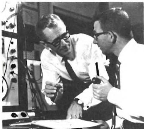
Quando la cera si solidificò e l'alta tensione fu interrotta fra le piastre, il fisico controllò la carica superficiale della cera. L'elettrete così formato possedeva una forte carica elettrostatica, che rimase costante per parecchi mesi.
