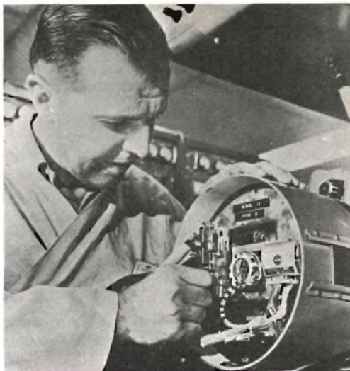
Fig. 5 - L'accelerometro, o tachimetro spaziale, rileva qualsiasi variazione dell'accelerazione della capsula nello spazio, e comunica tali variazioni al sistema di controllo della navigazione.
