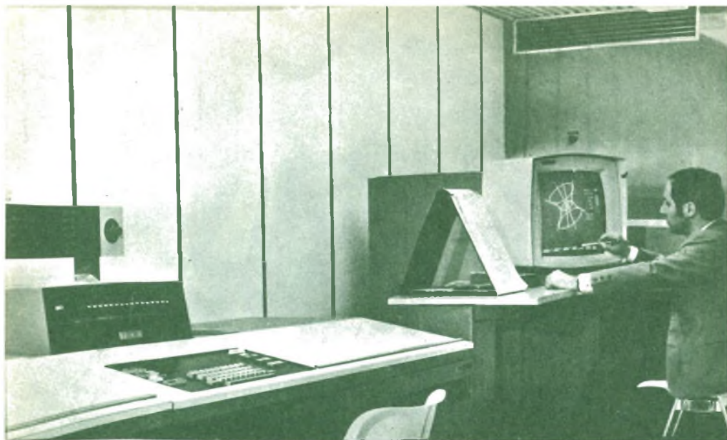
Fig. 2 - Interno dell'automezzo in cui sono installati il calcolatore IBM 1130 e l'Unità Video 2250.
