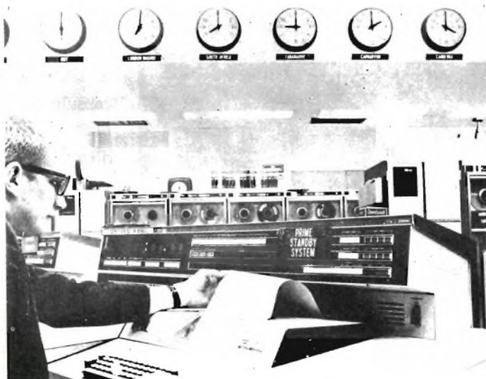
Fig. 2 - Uno dei 48 elaboratori UNIVAC 1230, installati presso le stazioni di rilevamento e di controllo sia terrestri, sia navali.
