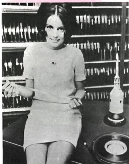
Fig. 4 - In otto metri di nastro magnetico è contenuto l'intero programma usato dagli elaboratori UNIVAC 1230 per ricevere i dati dalla capsula Apollo e trasmetterli al Centro Goddard.
