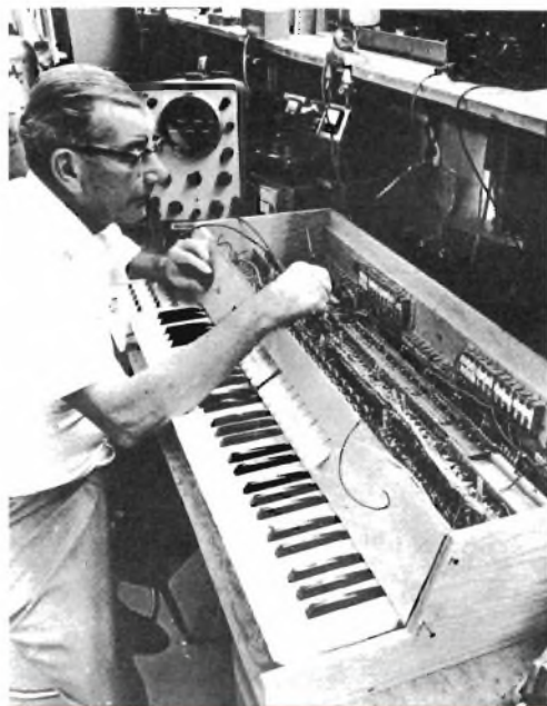
Questo organo elettronico della Motorola, delle dimensioni di 100 x 60 x 15 cm, comprende una tastiera di 61 note, 18 funzioni e registri ed un circuito di memoria unico nel suo genere.
