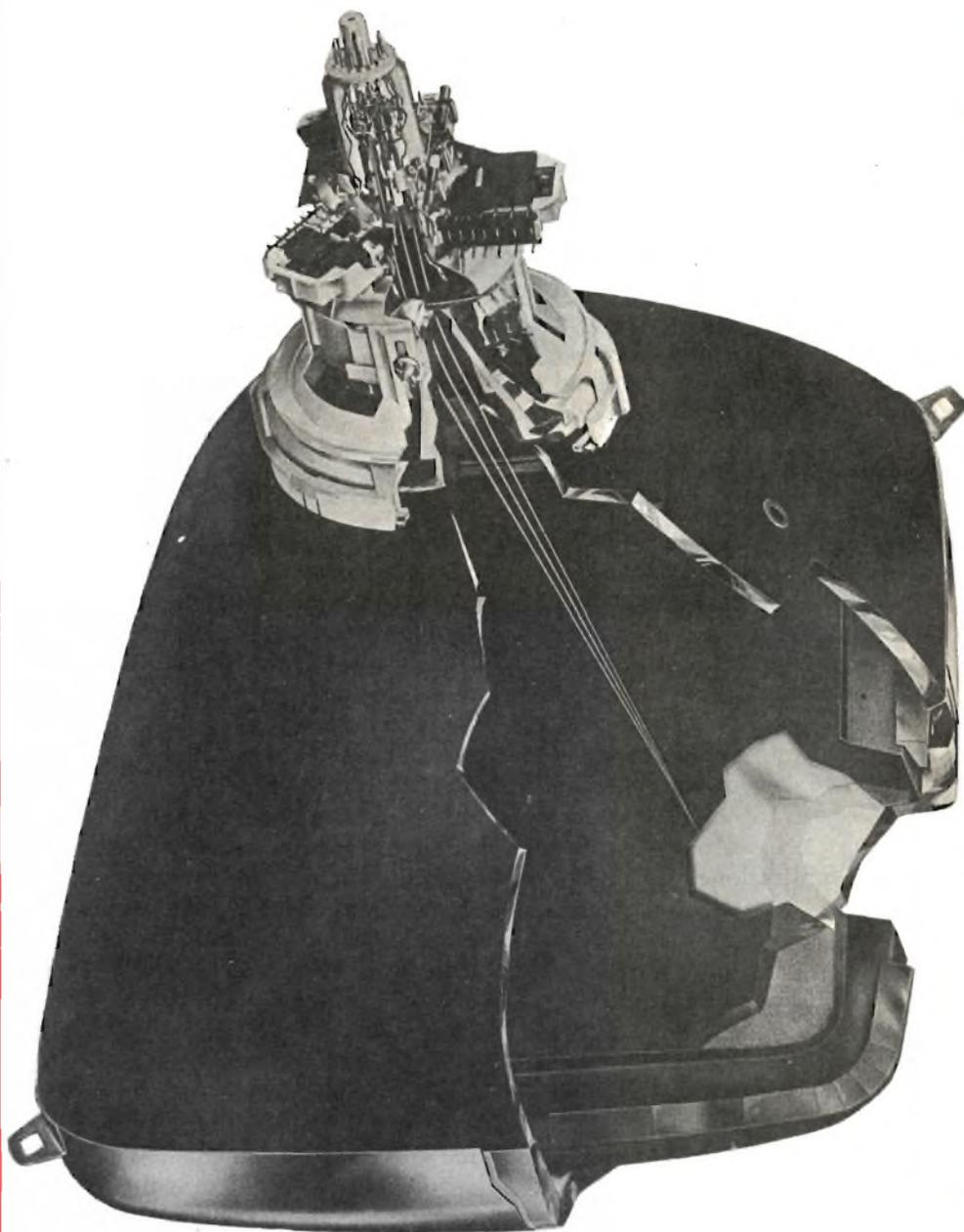
**Fig. 2 - Spaccato indicante la costituzione interna del cinescopio a maschera forata Philips tipo A 63-11 X e la posizione delle varie unità sul collo del cinescopio medesimo.**
