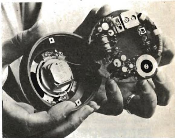
**Vista interna del ricevitore portatile IC 2000 a circuiti integrati presentato dalla Philips. Nella parte superiore si nota l'antenna in ferroceptor, il condensatore variabile (a sinistra) e le cellule d'energia, le quali si possono ricaricare.**
