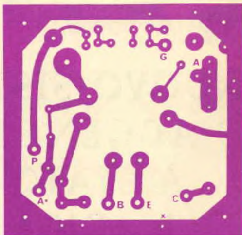
Fig. 2 - Rappresentazione del circuito stampato, usato per il montaggio, in grandezza naturale.
