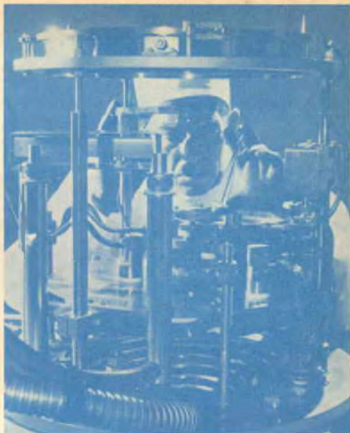
Fig. 8 - Camera a vuoto utilizzata dalla Marconi Instruments per la deposizione di nichelcromo ed oro durante la preparazione di microcircuiti.
