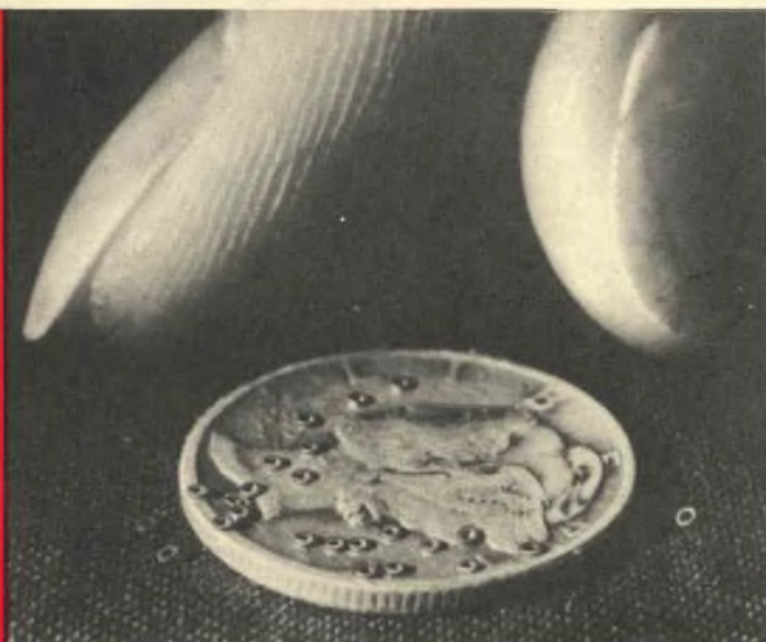
Fig. 3 - I nuclei miniaturizzati realizzati dalla IBM per il calcolatore di guida del Saturno sono così piccoli che sulla moneta possono trovare posto circa 545 unità.
