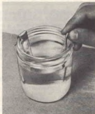
Gli elettrodi si realizzano con una striscia di latta ed un filo d'alluminio.
