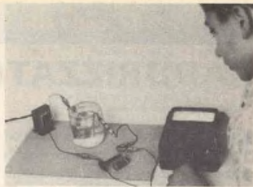
Fig. 2 - Il raddrizzatore finito può essere usato come un diodo al silicio. Collegati gli elementi del filtro come si vede nello schema, si misura la tensione di uscita con un voltmetro in c. c., come risulta dalla fotografia qui a destra. Aumentando le dimensioni dell'elettrodo di alluminio, si ottiene un aumento della corrente che il raddrizzatore chimico può sopportare.
