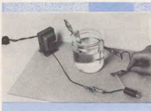
Fig. 1 - La pellicola semiconduttrice viene formata collegando il raddrizzatore ad una lampadina. Il trasformatore è del tipo per campanelli. Sopra è rappresentato lo schema del circuito ed a destra se ne vede la realizzazione pratica.
