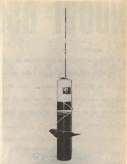
Il radiofaro costruito dalla Burndep't come si presenta dopo il lancio; si noti l'aereo ora eretto.
