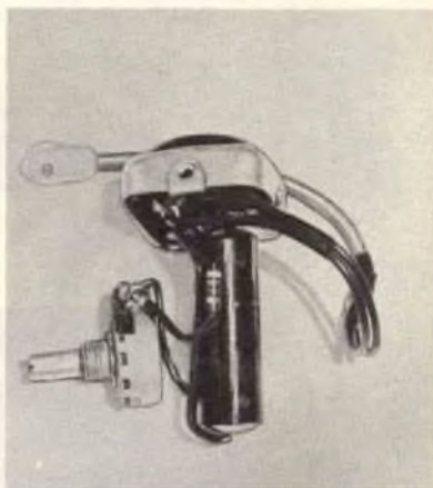
Ecco l'adattatore senza la scatoletta: per inserirlo in essa si infila l'alberino del potenziometro nel relativo foro e poi si stringe il dado.
