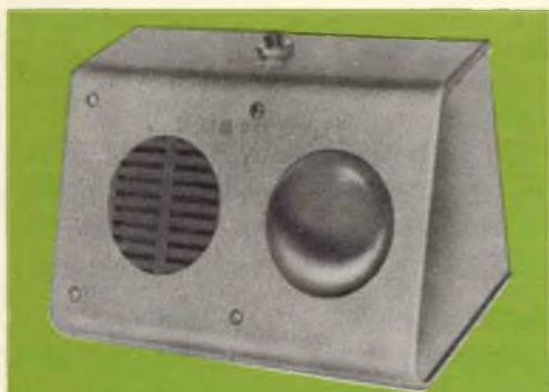
Il prototipo del sistema d'allarme è montato in un mobiletto con pannello frontale inclinato sul quale è visibile, a sinistra, il foro per l'altoparlante. Si può usare però una scatola di forma diversa.
