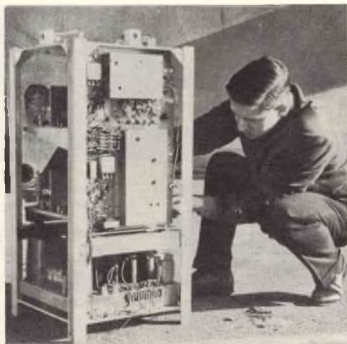
Regolazione finale dell'elaboratore di dati, dei temporizzatori e dei trasmettitori situati su Mamos.
