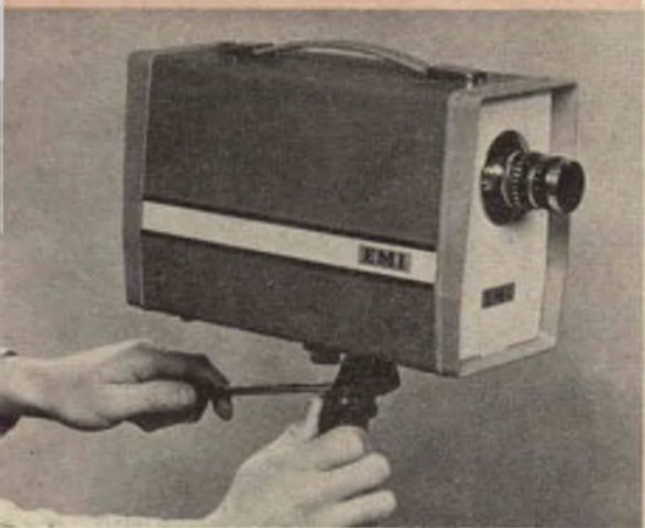
Telecamera della E.M.I. interamente transistorizzata.
