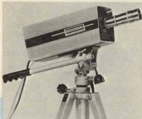
Telecamera TC 350 costruita nei laboratori Dumont della Fairchild per trasmissioni in circuito chiuso.
