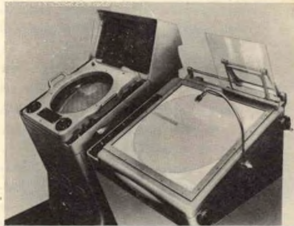
Una delle caratteristiche del nuovo radar Decca tipo 969/ARP consiste in una superficie tracciante mobile che fornisce una rapida e semplice soluzione dei problemi inerenti al tracciamento ed alla navigazione. L'unità tracciante è transistorizzata e gli echi del radar sono automaticamente trasferiti sulla superficie di carta dell'unità.
