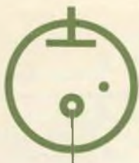
I regolatori di tensione a gas hanno tra anodo e catodo una caduta di tensione costante.
