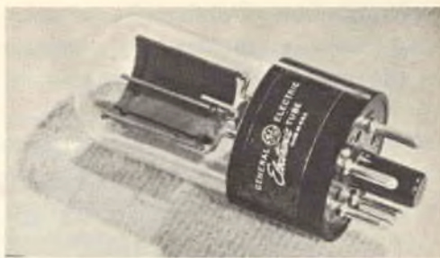
Un tipico fototubo costruito dalla General Electric.
