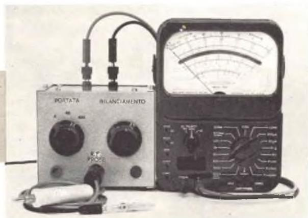
L'adattatore si collega alle boccole di ingresso dello strumento di misura nel modo indicato a sinistra. Può essere disinserito in ogni momento consentendo così di usare lo strumento di misura nel modo solito.
