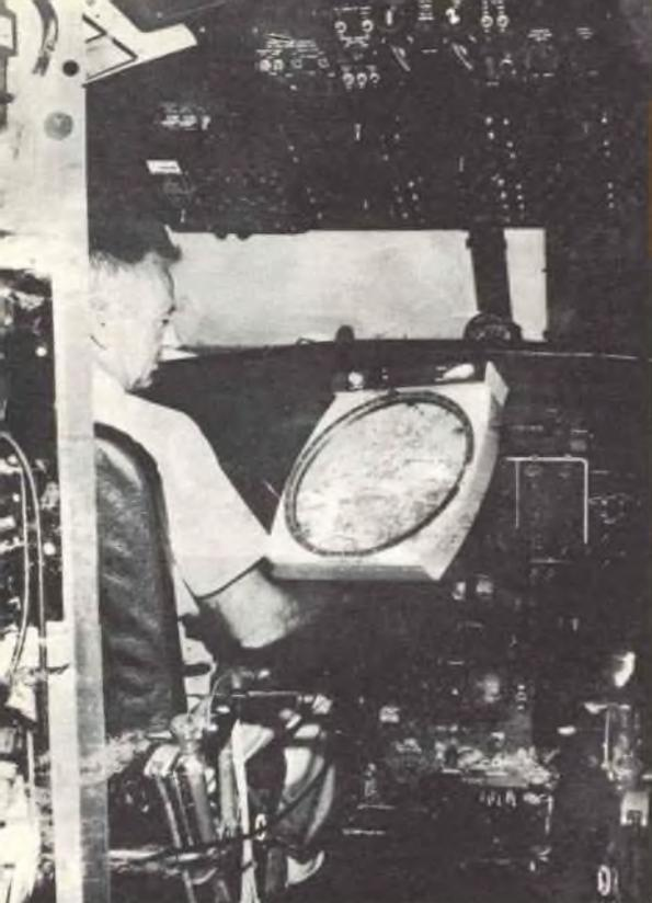
Il tracciatore di rotta automatico (a sinistra) consente al pilota di procedere guardando soltanto la carta sulla quale sono indicate la sua rotta e la posizione. Con questo dispositivo il pilota non incontra difficoltà alcuna a guidare l'aereo in qualsiasi direzione.
