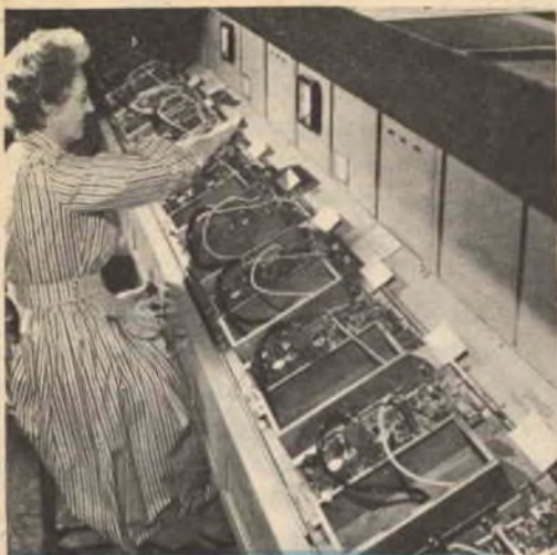
Macchina automatica per il collaudo e la taratura di circuiti stampati già montati.
