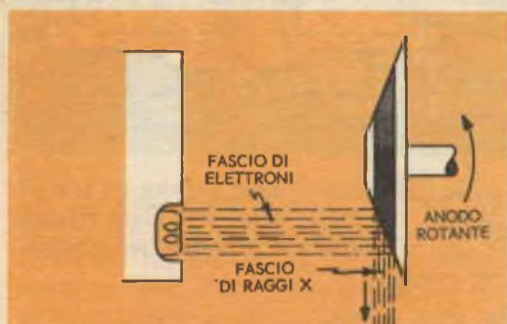
Fig. 4 - Con la realizzazione dell'anodo rotante si offre sempre una nuova faccia al fascio di elettroni, in modo da distribuire su un'ampia superficie il calore prodotto.
