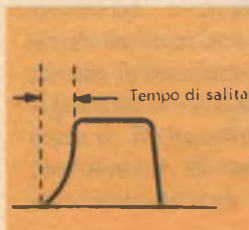
Fig. 2 - Il "tempo di salita" è l'intervallo di tempo richiesto ad un'onda quadra per raggiungere il suo massimo valore positivo o negativo. Nello schema, per chiarezza si è indicato un "tempo di salita" volutamente eccessivo.
