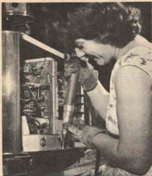
Operazione di fissaggio del telaio nel mobile.
