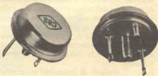
Nuovi transistori di potenza da 85 W realizzati dalla CBS. Una di queste unità può sostituire due transistori da 40 W o quattro da 20 W, in parallelo.
