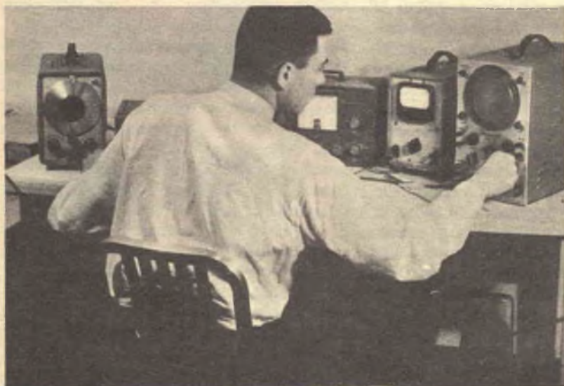
Fig. 2 - Complesso degli strumenti necessari per la misura della distorsione armonica; l'oscilloscopio non è indispensabile, però mostra la reale forma d'onda del segnale dando una indicazione visuale della distorsione.
