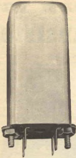
Fig. 1 - L'intero amplificatore è di piccole dimensioni o può essere sistemato in un normale schermo per trasformatore di frequenza intermedia. La paglietta di massa serve come punto di ancoraggio per l'ingresso del segnale o per il terminale positivo della batteria da 6 V; un capo dell'altoparlante è collegato al terminale negativo B- della batteria.
