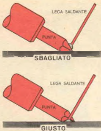
Fig. 3 - Una buona tecnica di saldatura richiede che la lega saldatante sia applicata non sul saldatore, ma nel punto di contatto fra la punta del saldatore e l'elemento da saldare.
