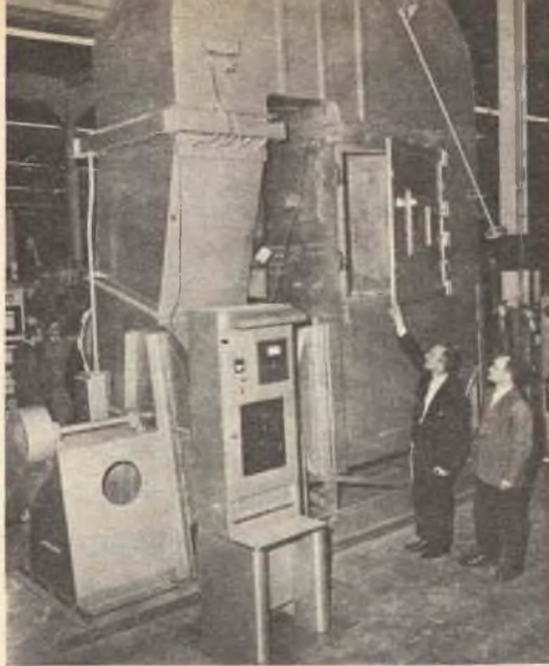
Fig. 6 - La camera che simula tempeste di sabbia e di polvere viene ispezionata appena prima della spedizione dagli stabilimenti della Tenney.
