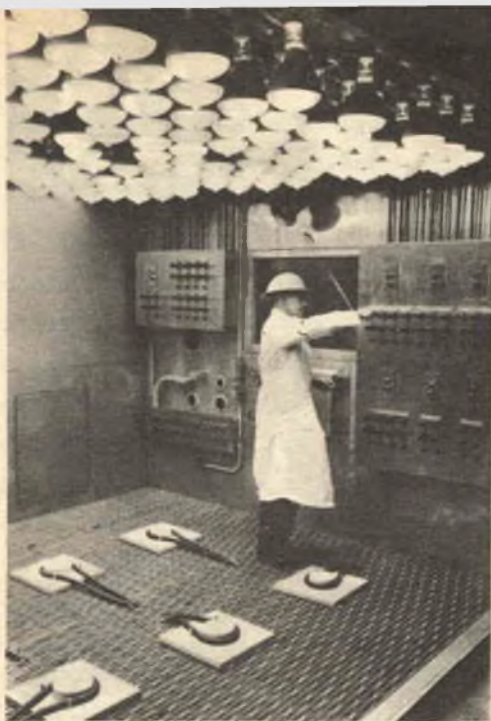
Fig. 3 - La prova di « pieno sole » su cavi di alimentazione sistemati su supporti di legno, è qui eseguita da un tecnico che sta appunto regolando l'intensità « solare ».
