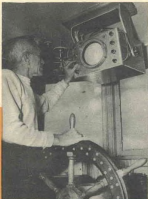
L'installazione radar sul soffitto fa risparmiare spazio e permette una diacosa più corta dell'antenna sistemata direttamente sopra la cabina del timoniere.
