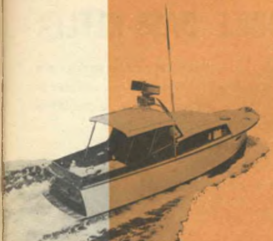
Un radar leggero ed economico può essere installato su un battello di 9 metri senza sovraccaricare le batterie di bordo.
