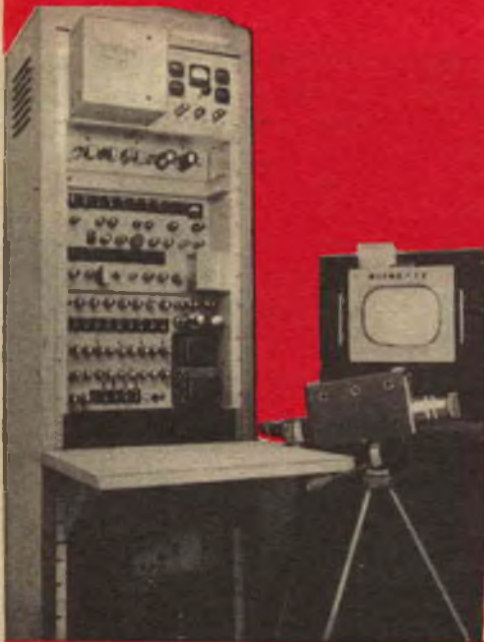
Il trasmettitore costruito da Arnold Proner, ingegnere presso la NBC, comprende un amplificatore-trasmettitore, una camera vidicon e un apparecchio di controllo. La maggior parte delle apparecchiature è simile ai primi apparati TV commerciali.
