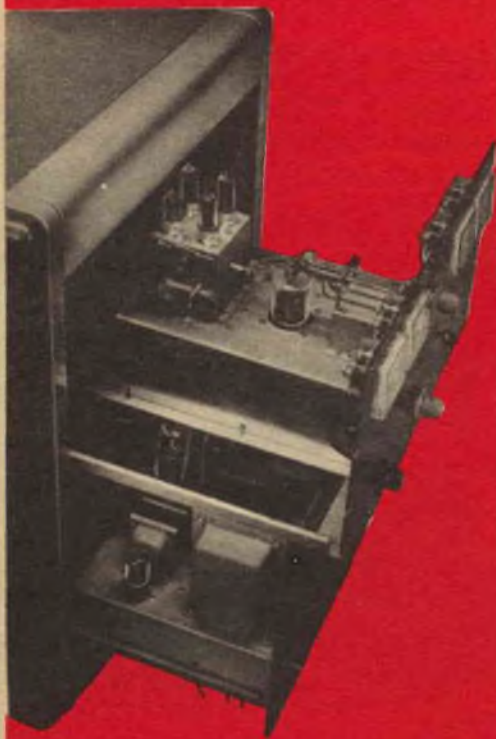
Il trasmettitore costruito da Arnold Proner, ingegnere presso la NBC, comprende un amplificatore-trasmettitore, una camera vidicon e un apparecchio di controllo. La maggior parte delle apparecchiature è simile ai primi apparati TV commerciali.
