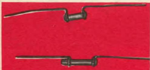
Condensatori ceramici a tubetto con coefficiente di temperatura definito per usi generali.
