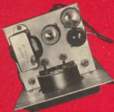
In questa voltmetro elettronico i quattro controlli di taratura sono raggruppati intorno allo strumento.
