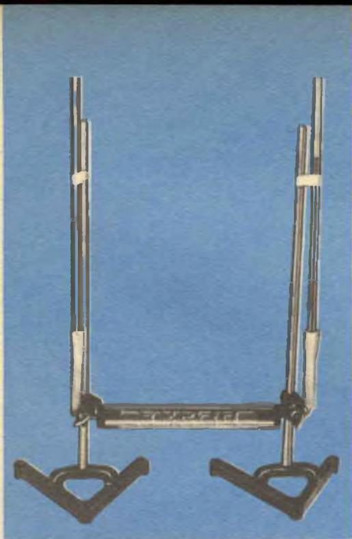
Unità di pompaggio perfezionata. E' composta da cinque separate pompe dielettriche tipo « corona », accaglionate nel cilindro di vetro per avere un'azione di pompaggio più potente.
