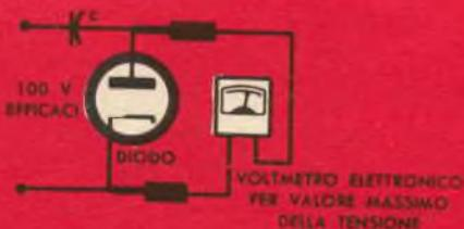
**4** Al circuito illustrato, Araldo Traffigi applicò 100 V efficaci e usò il suo voltmetro elettronico per misurare la tensione massima ai capi del diodo. Quanto trovò? Per facilitare il problema, supponiamo che la tensione applicata sia sinusoidale.
