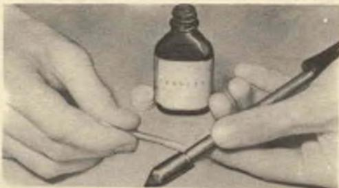
**S**e il vostro saldatore ha la punta avvitata o ha una vite di pressione che tiene a posto la punta stessa, controllate che l'ossidazione non la blocchi. Se ciò è avvenuto, non tentate di evitare le parti con le pinze, poiché danneggerete la punta. Prendete invece un po' di cotone o un pennellino, intingetelo in ammoniaca e applicatelo alla punta com'è illustrato nella foto: in pochi minuti la punta sarà sbloccata.
