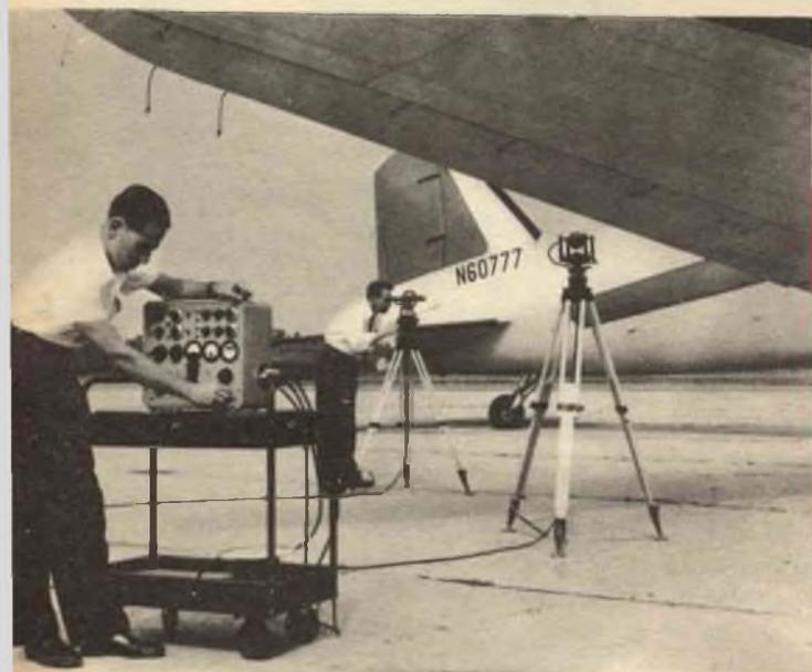
Alcuni ingegneri stanno facendo « ruotare il mondo » intorno ad un aereo fermo, per tarare con precisione il sistema di bussola dell'aereo stesso e compensare gli errori. Questo metodo permette a due uomini di controllare e di regolare la bussola di un missile o di un aeroplano in 3 ore, mentre prima la stessa operazione richiedeva l'opera di una squadra e una giornata di lavoro.
