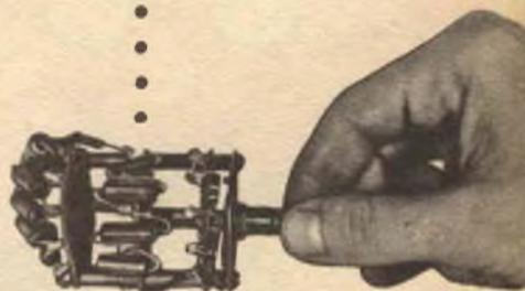
Commutatore di portata di un voltmetro elettronico. I resistori, per ottenere una buona rigidità, sono collegati direttamente ai terminali del commutatore.
