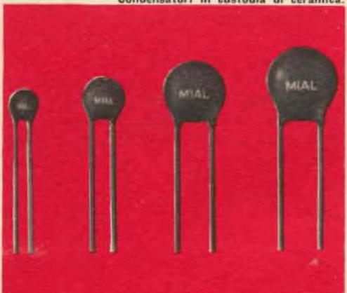
Condensatori ceramici a disco, adatti per l'impiego nei circuiti di alta ed altissima frequenza, dove siano richieste minime dimensioni con media stabilità.
