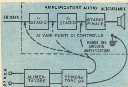
Impiego del generatore BF. Come procedere, con esso, ad un rapido e sistematico controllo di un circuito BF.
