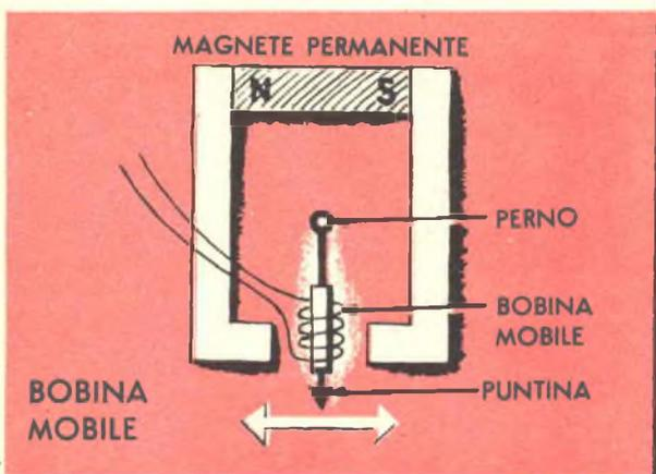
Un generatore elettrico in miniatura, del tutto identico, come principio, ai grandi alternatori delle centrali elettriche, forma un pick-up a bobina mobile. La puntina fa muovere una piccola bobina in modo che essa tagli il campo magnetico di un magnete permanente. Ciò induce tensione nella bobina mobile.
