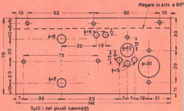
Fig. 2 e fig. 3 - Pannello e telaio.
