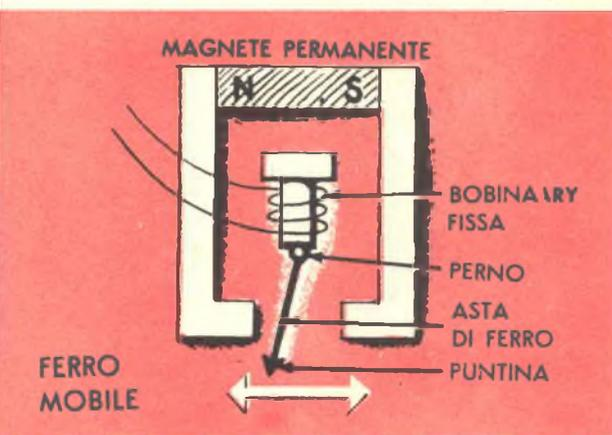
Il principio dei pick-up a ferro mobile è simile a quello dei pick-up a bobina mobile. Qui la bobina è fissa; varia il campo magnetico. La puntina fa muovere un'asta di ferro tra i poli della calamita e il campo magnetico che attraverso la bobina varia. Questo fatto induce tensione nella bobina fissa.
