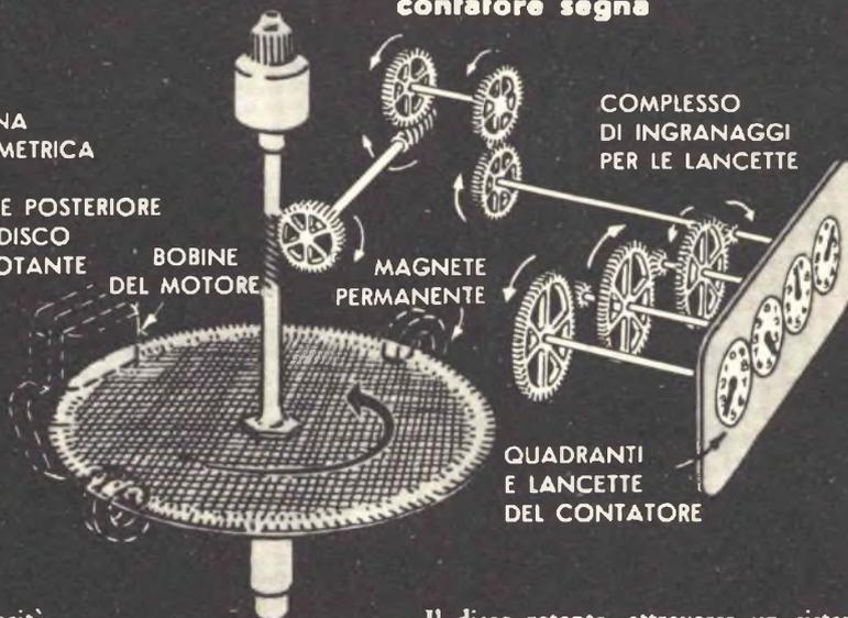
Il disco rotante, attraverso un sistema di ingranaggi fa ruotare le lancette dei quadranti che segnano la quantità di elettricità che voi avete usata.
