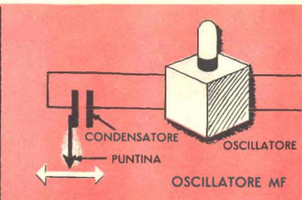
Questo è simile ad una piccola stazione radio MF. Il pick-up si comporta come un condensatore con una lamina mobile alla quale è collegata la puntina. Le vibrazioni della puntina variano la capacità, modulando un oscillatore MF. Unico pick-up MF è il Weathers, costoso e delicato ma le cui prestazioni sono veramente ottime e tecnicamente precise.
