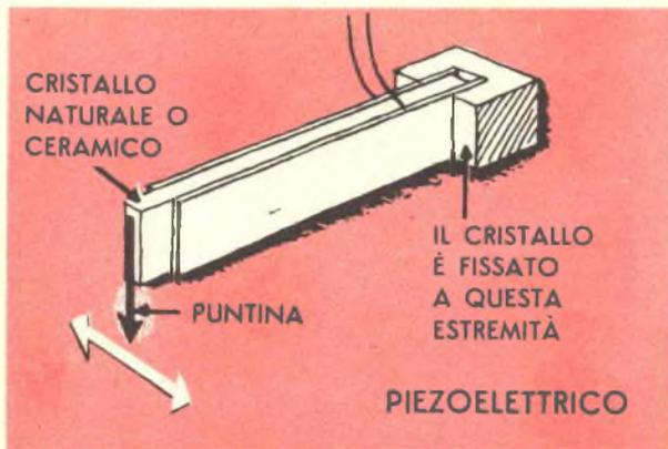
Strofinando certi cristalli si genera elettricità. I pick-up piezoelettrici non richiedono preamplificazione data la loro alta uscita. In molti di essi sono ora usati cristalli ceramici di titanato di bario ottenuti sinteticamente, che sono meno sensibili alla temperatura e all'umidità che i cristalli naturali.
