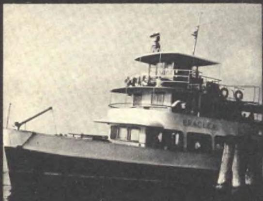
1 - L'Eraclea, una delle motonavi adibite al trasporto dei viaggiatori nel tratto di laguna San Marco-Lido. Sulla cabina di comando è visibile il radar che l'Azienda Comunale di Navigazione Lagunare sta provvedendo ad installare anche su altri natanti. Finora sono una decina le apparecchiature radar di cui si avvalgono i trasporti pubblici di Venezia per una sempre maggiore sicurezza.
