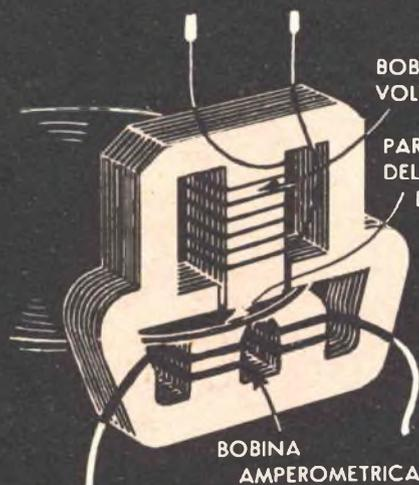
Il disco d'alluminio ruota, ad una velocità che dipende esattamente dalla potenza prelevata, per mezzo di un semplice motore ad induzione.
