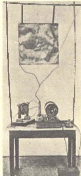
(Destra alto). Ecco il primo apparecchio trasmettente costruito da Marconi coi suoi propri mezzi: è visibile a sinistra il risonatore, e a destra il rocchetto di Ruhmkorf. In alto, la lastra, ricavata da un vecchio bidone, che, in un primo tempo, funzionò da primitiva antenna.
