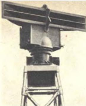
4 - Lo scanner, o scrutatore, è la parte aerea dell'unità di esplorazione dell'apparato radar. L'equipaggiamento pesa circa 90 kg e costa tre milioni.
