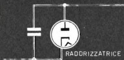
Fig. 3 - La valvola raddrizzatrice può essere origine di ronzio; esso può essere eliminato shuntando la valvola stessa con un condensatore di valore compreso fra i 500.000 e i 100.000 pF.
