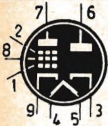
6BY8 DIODO-PENTODO AMPL. MF-RIV. (zoccolo noval)
