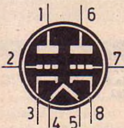
6BX8 DOPPIO TRIODO AMPL. VHF (zoccolo noval)
