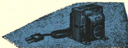
Il trasformatore con rapporto 1/1, inserito fra la presa luce e il televisore, isola quest'ultimo dalla tensione di rete.
