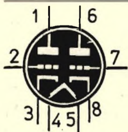
6BN7 DOPPIO TRIODO AMPL. OSCIL. (zoccolo noval)
