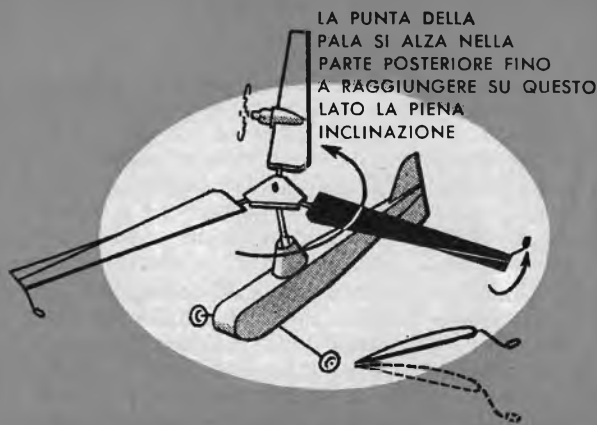
Fig. 6 - Le pale si alzano nella parte posteriore, a sinistra, per ricevere in pieno l'aria. Se non c'è il vento la spinta all'indietro dà una forza di salita minore e le pale completamente inclinate equilibrano quelle ad inclinazione ridotta del lato opposto mentre l'elicottero vola orizzontalmente.
