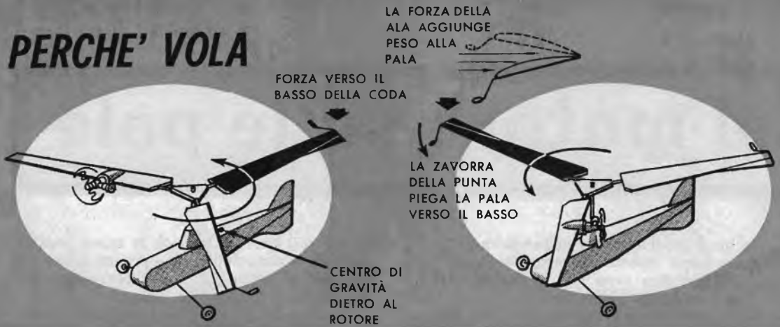
Fig. 3 - Per mantenere l'elicottero in posizione orizzontale, le pale rotanti devono diminuire la loro inclinazione sulla spinta in avanti, per equilibrare la diminuita forza di elevazione della spinta all'indietro. Ciò si ottiene zavorrando la coda del modello così da imprimerle una spinta verso il basso.
