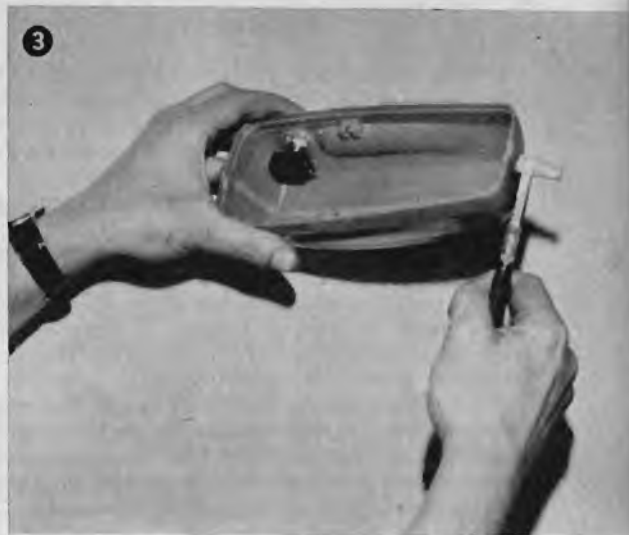
Fig. 1 - Il primo componente che si deve applicare alla calotta di plastica è l'interruttore; la rondella esterna va avvitata aiutandosi con un cacciavite.
