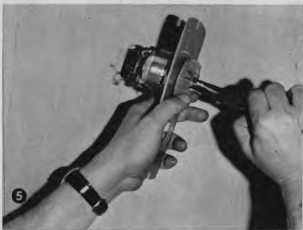
Fig. 4 - L'applicazione del motore alla piastrina di base viene effettuata mediante l'avvitamento di due dadi alle due viti uscenti dal pacco lamellare.
