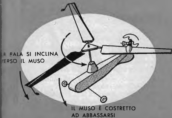
Fig. 5 - Le punte delle pale, agendo come giroscopi, reagiscono alla forza esercitata dall'aria sul lato destro, inclinandosi anteriormente verso il basso. Ciò fa inclinare il muso dell'elicottero verso il basso mentre esso, essendo zavorrato in coda picchia in avanti per un volo diritto.
