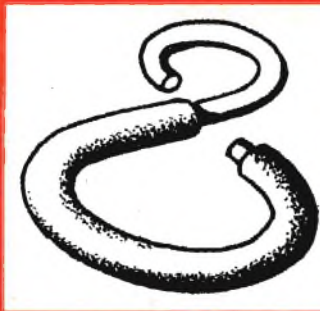
Fig. 4 - Un tipo molto comune di gancio è costituito da un rocchetto di legno duro, direttamente inserito nell'asse dell'elica. Fig. 5 - Tutti i ganci di acciaio armonico devono essere rivestiti con un tubetto di gomma o di materia sintetica.
