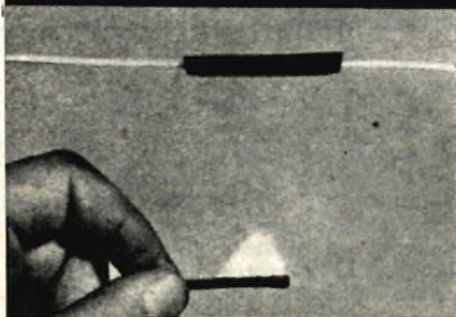
Fig. 1 - L'isolamento della saldatura si effettua in due tempi. Prima si introduce nel conduttore un tubetto di gomma e poi si effettua la saldatura. In un secondo tempo si ricopre la saldatura col tubetto e mediante un fiammifero si provoca la fusione delle sue estremità.
