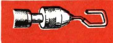
Fig. 9 - L'elica va trattenuta per mezzo del gancio caricatore applicato al trapano, in modo da accelerare il caricamento.
