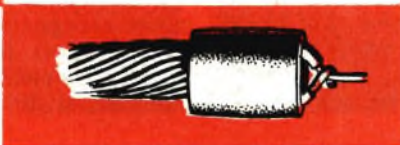
Fig. 8 - Per impedire la fuoriuscita di fili si può applicare all'estremità della matassa un tubetto di gomma.
