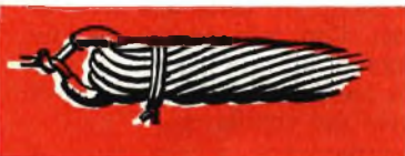
Fig. 7 - Per impedire la fuoriuscita di qualche filo, occorre legare la matassa immediatamente dietro il gancio.
