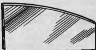
Fig. 8 - Un frammento di vetro a rottura curvilinea serve per ricavare la curvatura della pala dell'elica.
