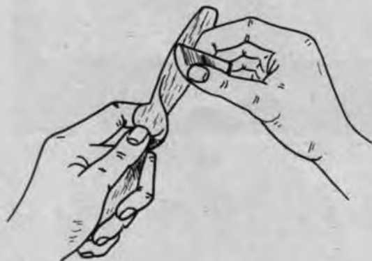
Fig. 7 - La lisciatura dell'elica va fatta con un pezzetto di vetro.
