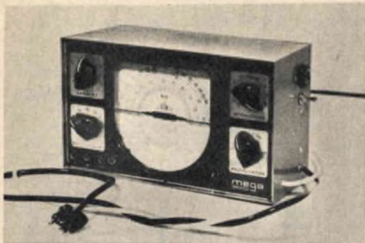
Fig. 2 - Così è fatto l'oscillatore modulato, cioè lo strumento radioelettrico indispensabile per una precisa e corretta taratura del ricevitore.
