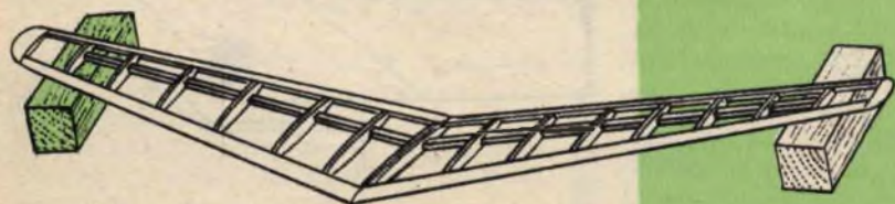
Fig. 11 - Le due semiali devono essere costruite separatamente ed unite tra di loro quando sono del tutto ultimate.
