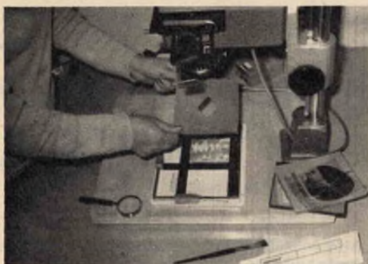
Fig. 12 - Così si rende più scura una sola parte dell'immagine. Il foro praticato nel cartone lascia passare soltanto una parte della proiezione.
