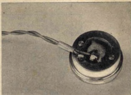
Fig. 7 - La fotografia mette in evidenza il sistema di collegamento dei conduttori al microfono di tipo magnetico. Uno dei due conduttori è quello di massa, l'altro è il conduttore « caldo ».
