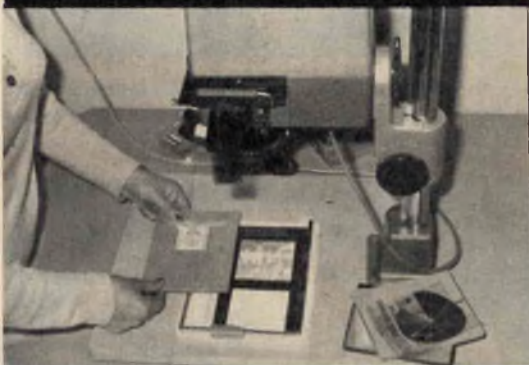
Fig. 9 a/b - Si esegue un provino del tempo di posa coprendo prima una parte e poi l'altra della carta sensibile durante l'esposizione.
