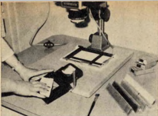
Fig. 4 - Prima di procedere all'ingrandimento fotografico occorre pulire il porta-negativi.
