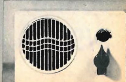
Fig. 3 - Una scatola di plastica per ricevitori portatili può essere utilmente impiegata come custodia per il metronomo.
