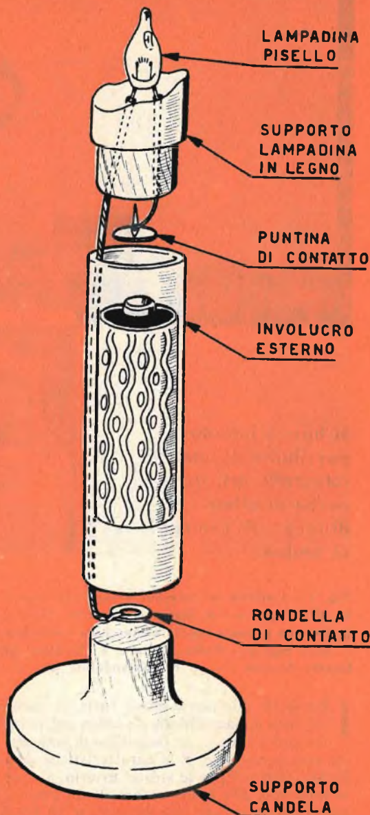
Fig. 1 - L'abilità nel costruire questa bugia elettrica consiste nel conferire al complesso la massima somiglianza con una candela di cera. Si noti a tale proposito la forma della parte superiore del supporto della lampadina che fa pensare alla consumazione della cera della candela.
