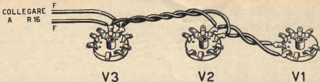
Fig. 3 - Realizzazione pratica del circuito di accensione dei filamenti delle tre valvole dell'amplificatore. Contrariamente al sistema usato nei comuni ricevitori, in cui un piedino dello zoccolo corrisponde al filamento vengono collegati entrambi all'avvolgimento secondario del trasformatore di alimentazione e ciò allo scopo di evitare il ronzio che, diversamente, verrebbe introdotto nelle valvole a causa della corrente continua.
