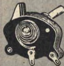
Fig. 1 - Schema elettrico del ricevitore (il particolare in basso, a destra, raffigura il condensatore variabile C1, così come esso è nella realtà).
