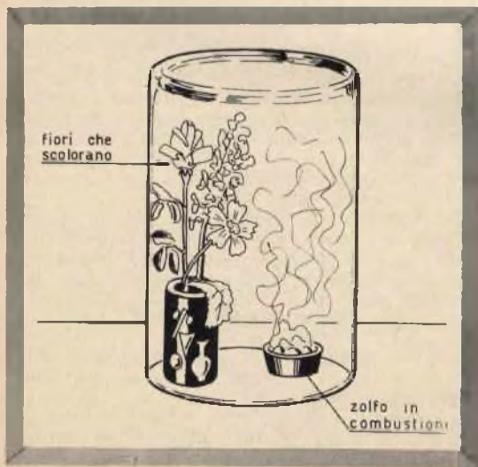
Fig. 1 - Ponendo un fiore sotto una campana di vetro in cui si faccia bruciare dello zolfo in polvere si ottiene un rapido e completo scolorimento del fiore stesso, di qualunque colore esso sia.
