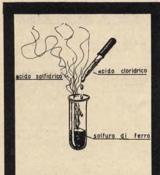
Fig. 3 - L'acido solfidrico, detto anche idrogeno solforato, si ottiene versando in una provetta, contenente del solfuro di ferro, dell'acido cloridrico, lentamente, mediante un comune contagocce.
