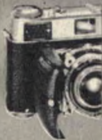
Fig. 2 - Le macchine fotografiche di tipo moderno dispongono di accessori non essenziali al fine ultimo della fotografia, ma di grandissimo aiuto all'operatore: tra essi va ricordato il mirino per la inquadratura o la messa a fuoco (a sinistra) ed il regolatore dei tempi di esposizione (a destra).
