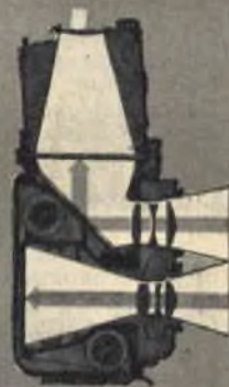
Fig. 4 - La macchina tipo Rolleiflex senza costretto da due camere sovrapposte: quella superiore proietta l'inquadratura, quella inferiore proietta l'immagine sulla pellicola.
