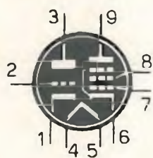
18GV8 TRIODO-PENTODO PER USO TV (zoccolo noval)
